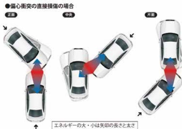
偏心というのは、車両重心からずれた方向で外力が入ってくるような事故である。一番左の図は、進行方向に対して対向車の前側の右側に角度を有しながら接触している。接触された自動車は、接触したときに進行方向を変えるエネルギーに代わっていることを示している。偏心衝突によくいわれる進行方向を変えるエネルギーに衝突エネルギーが変わったということで衝突の際の損傷は軽減されるという例である。
