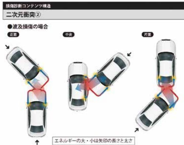
これは、双方の車が出会い頭などで衝突した場合である。衝突してエネルギーがそれぞれの車に波及している図である。当たった着力点からエネルギーの方向が波及している方向を図に示したものである。エネルギーの波及方向に関してもご意見をいただきたい。
