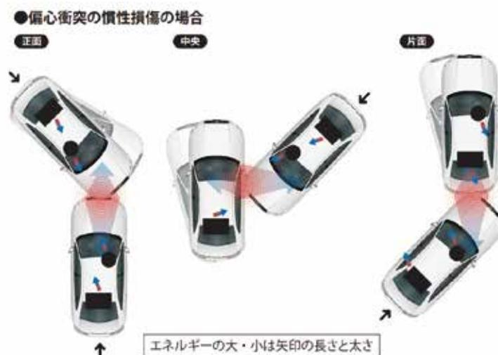
これも先ほどと同じパターンでぶつかった車が動かなかった場合、もしくは当たった際に片方の車が進路方向をエネルギーで変えられた場合、慣性損傷にどのような変化があるか、という図である。
