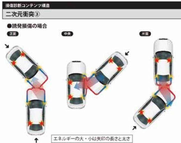
今度は、スピードと質量が変わった車、大きな車でさらに高速になった時の2次元の衝突である。これは、どちらかが大きい小さいがあると思うが、当たった際の波及の方向とエネルギーの波及が大きくなって波及はどんどん車の深部へと移行して行ってさらに誘発損傷まで行ったという図である。車が動いている場合で損傷が見受けられたという例である。
