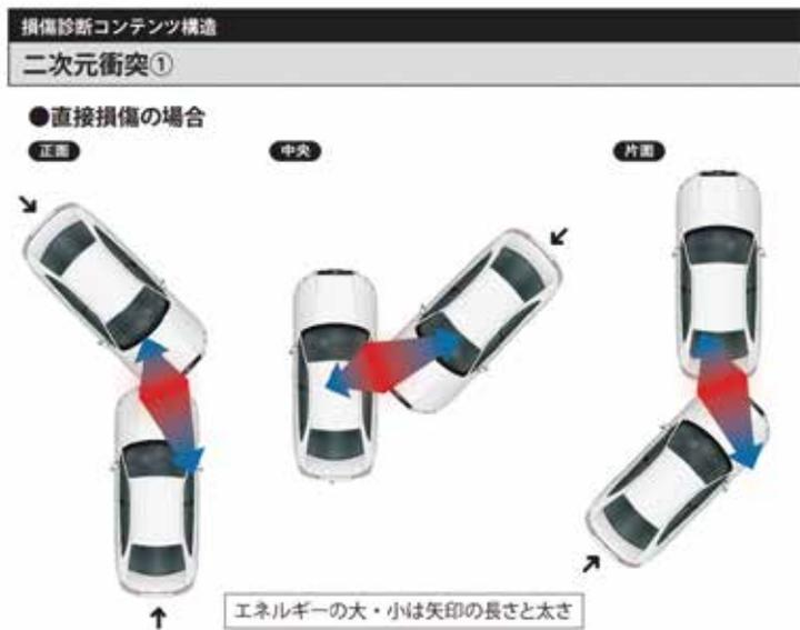
次は、2次元衝突である。2次元というのは、進行方向に対して入力に角度を有するものである。車両の縦軸に対して角度を有する方向で入力があった場合、を2次元と呼んでいる。いわゆるXYでいうとX方向の角度があった、水平力がここに加わったと想定してほしい。そういう角度で当たった場合である。真正面ではなく進行方向がずれているという形である。こういった事故を2次元衝突と呼んでいる。これも先ほどと同じように着点は大い赤丸で示している。接触して大きな膨らみがあって、だんだんエネルギーの消滅に繋がって青い方向にエネルギーの消滅の度合いを矢印として表している。
