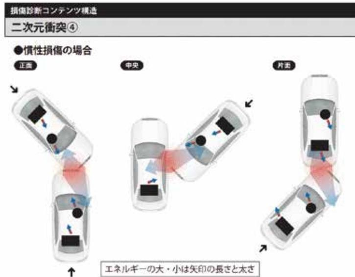
これは、慣性は2次元衝突にあたるので、一旦車が衝突して車の損傷は終わったが、積載物が慣性を継続するので、慣性を持ったものが移動したことによって何か損傷したという例である。
